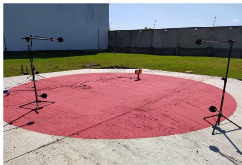
Fig.3: Detalhe da amostra durante ensaio com Raio de 3 metros.
